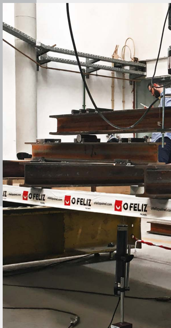
Ensaio de flexão do painel completo
